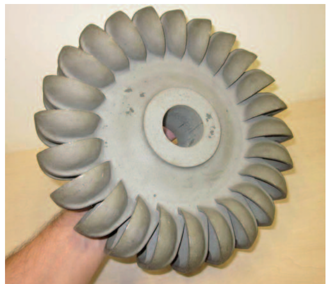
Foto 1 - Una ruota di micro turbina tipo Pelton in lega fusa in cera persa
