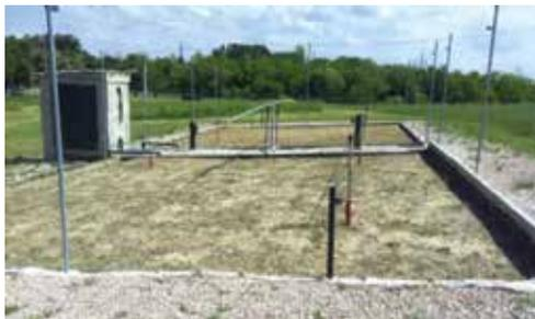
Fig. 8: Scorcio del Campo Sperimentale di Ingegneria delle Acque del Dipartimento di Ingegneria Civile ed Ambientale dell'Università degli Studi di Perugia: vista delle due parcelle equipaggiate con misuratori del deflusso superficiale e di fondo e con un sistema TDR per la misura del contenuto d'acqua.
